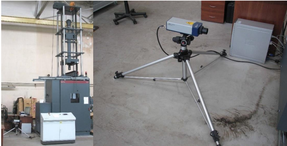
Рисунок 2.1 – Общий вид копра DWT-60 и лазерной измерительной системы.
