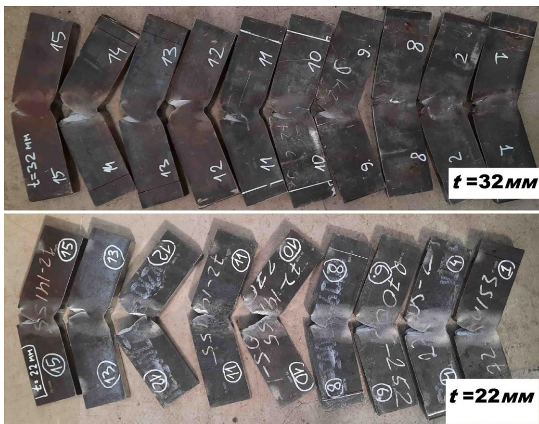
Рисунок 2.6 – Вид образцов, неразрушенных ударом бойка.
