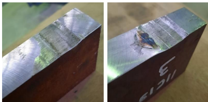
Рисунок 3.2.5 – Отличие мест контакта с опорами двух половинок одного образца из стали K65 испытанного при 20 °С.
