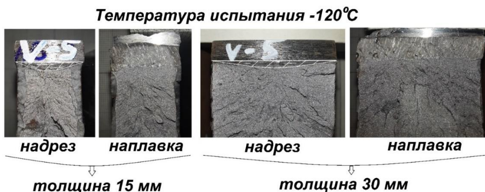
Рисунок 3.3.8 – Сравнение условий старта трещины в образцах с надрезом и наплавкой.
