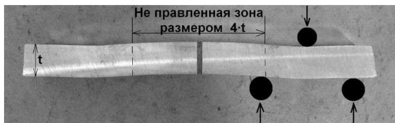
Рисунок 3.3.1 – Схема правки полнотолщинных образцов ИППГ толщиной 27 мм с направленной центральной частью.
